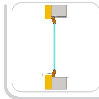
Prinzipische Skizze: Anschluss Dämmebene zum Fenster
