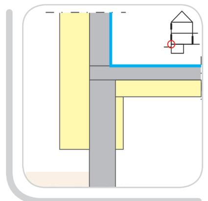
Prinzipkizze: Dämmung Außenwand, ergänzend zur bereits gedämmten Kellerdecke
